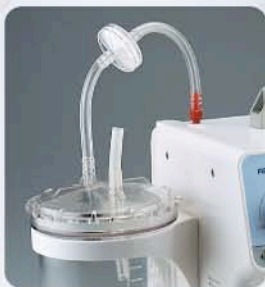
紅色接頭插入儀器本體 VACUUM孔處，另一端接往吸引瓶蓋 VACUUM接頭
